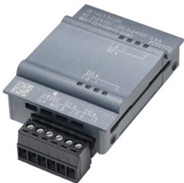
SIMATIC S7-1200, DIGITAL I/O SB 1223, 2 DI / 2 DO, 2 DI 24V DC/2 DO 24V DC
